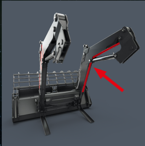
Montarea țevilor pentru REAL 3 rd
